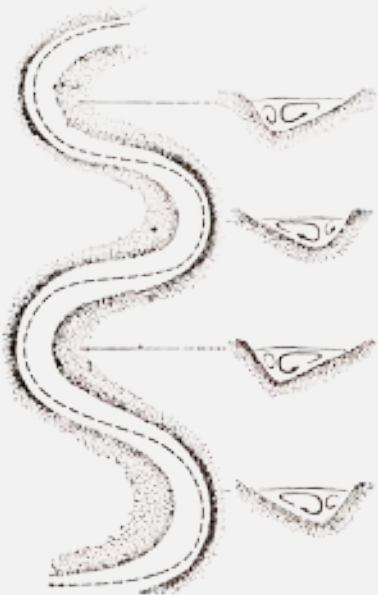
Le correnti secondarie rotatorie hanno una forza diversa dove il fiume fa una curva. La corrente più grande della sponda piana diventa la più piccola della sponda ripida nella curva successiva
